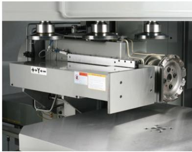
素材寸法を入力するとテーブル中心にワーク中心がセット出来るよう自動で位置決め板が所定の位置に動きます。
