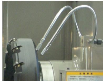
オイルミストを使用することにより、加工面状態が良く仕上がり、チップの寿命が延びます。
