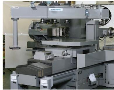
クレーンで吊り下げたワークをセットする際に門形クランパーを旋回することにより、段取りが容易になります。
