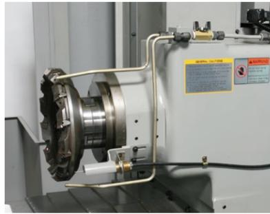
加工中に切粉を巻き込まないように、エアブローで切粉を飛ばします。
